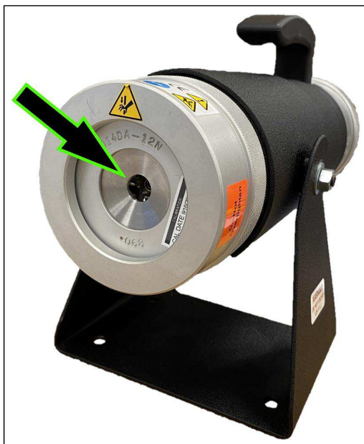
Obrázek 9: Umístění měřidla GO/NO GO
