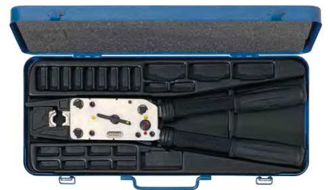
robuste mechanische Zweihandcrimpzange im Metallkoffer zum Vercrimpen von Kabelschuhen und Verbindern bis 120 mm 2 Ruggedly designed two-hand tool for crimping cable lugs and connectors with cables up to 120 mm 2 , in a metal case
