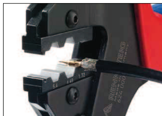
Обжим внутреннего сердечника Inner conductor crimp
