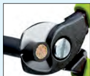
Bild 2: Kabelschnitt mit Kabelschneider: leichter, sauberer Schnitt ohne Verformung des Kabels
